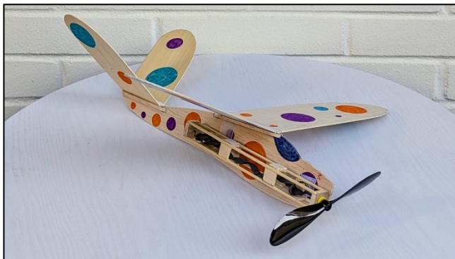
Ein Modell mit einer „Gummimotor-Antriebseinheit“, die an mehreren Modellen verwendet werden kann.
