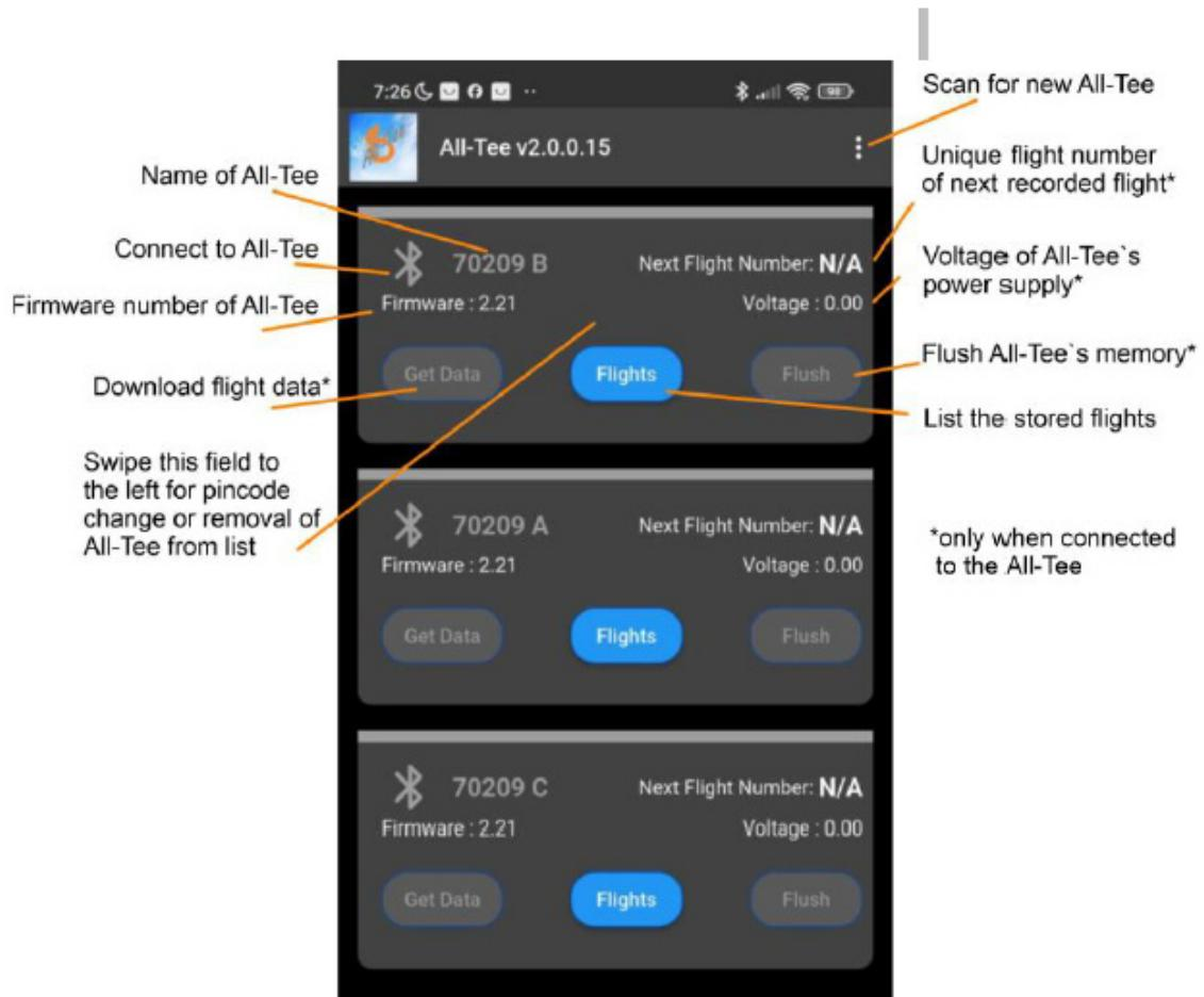
Schalten Sie den All-Tee ein, indem Sie ihn an eine Batterie oder eine andere 3,4-10-V-Stromquelle anschließen. Warten Sie, bis entweder die grüne oder die gelbe LED gleichmäßig blinkt. Wenn die LED gelb blinkt, ist die Bluetooth-Funktion eingeschaltet. Wenn sie grün blinkt, sind keine Flugdaten verfügbar und Bluetooth ist ausgeschaltet. Wenn die LED grün blinkt, ist keine
