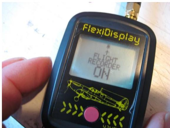
Ein blinkendes '\*' erscheint in der Mitte der oberen Zeile des Locator- und Höhenmesser-Displays während des Betriebs und bleibt bestehen, bis die Aufzeichnung gestoppt wird oder der Aufzeichnungsspeicher nach ~20 Minuten voll ist. Es sind mehrere Aufzeichnungen möglich, die jeweils separate Dateien erzeugen, die aus der Datei Config.ini heruntergeladen werden können (siehe 5.1.3).
