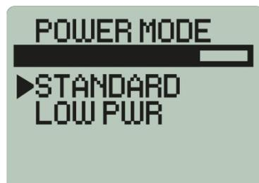
Energiesparmodus: Dieser Modus reduziert den Stromverbrauch auf nur 30 mA. Mit einem voll aufgeladenen Akku kann das Gerät bis zu 24 Stunden lang betrieben werden. Im Energiesparmodus sind die Bluetooth-Funktionen ausgeschaltet, und der Mikrocontroller arbeitet mit 20 MHz, was zu einem geringeren Stromverbrauch führt. Die Hintergrund-LED im Hauptbildschirm ist ebenfalls ausgeschaltet und blinkt nur, wenn ein Bakensignal empfangen wird.
