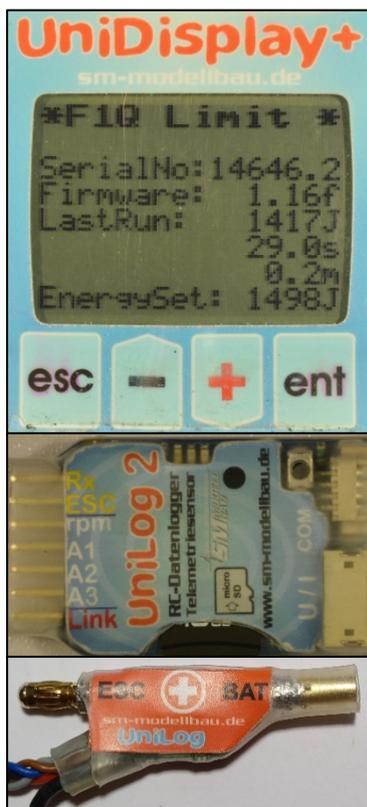
Spannungs-/ Stromsensor als Messglied mit einem Kabel angeschlossen wird. Davon sind zwei unterschiedliche Typen zertifiziert: Ein 40A/60V-Sensor und ein 20A/10V Sensor. Zur Konfiguration kann ein kleines mobiles Display oder ein PC-Tool verwendet werden.
