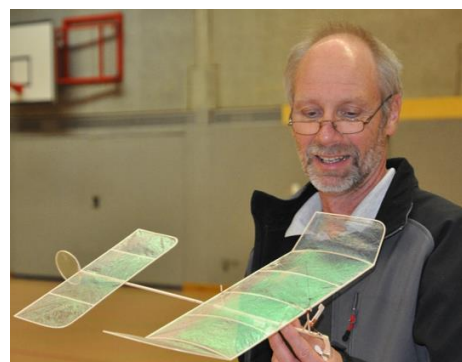
Abb. 6: Das eingesetzte Modell. Zum Stoppen des Motors schiebe ich einen Kurzschluss (z.B. etwas Balsa mit CU-Folie beklebt) zwischen die Schalterkontakte. Dadurch spare ich das Gewicht für den zusätzlichen Steckkontakt am Super CAP.
