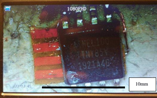
Abb. 4 & 5: Testschaltung für den Prozessor, unten endgültige Version unter dem Digital-Mikroskop, die Schaltstufe liegt auf der Rückseite
