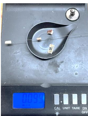
Abb. 3 und 4: mechanischer Aufbau, Gewicht 100mg
