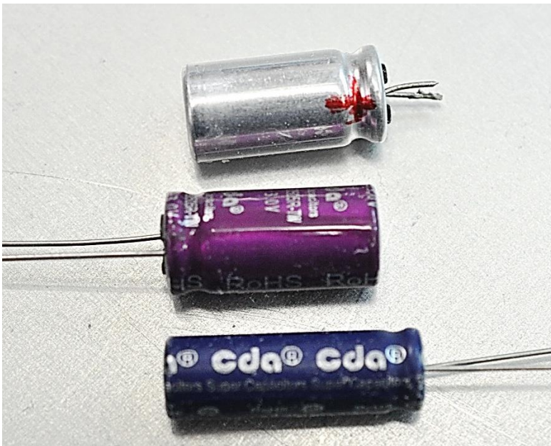
Verschiedene 5 Farad Supercaps. Abmanteln und Kürzen der Beine bringt 0,2 g weniger Gewicht.
