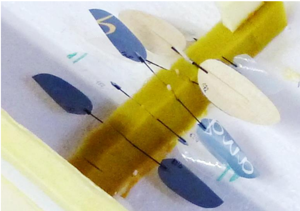
Verschiedene Propeller aus Folie und Balsa. Die Holme bestehen aus CFK (z. B. 0,6 mm)
