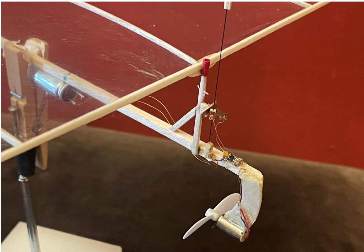
Deckenschalter mit CFK Antenne (schaltet den Motor bei Deckenberührung für einige Sekunden ab)
