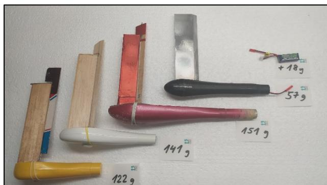
**Abb. 5: Gewichtsvergleich zu bisherigen Magnet-Steuerungen (Pauls Steuerung rechts oben).**
