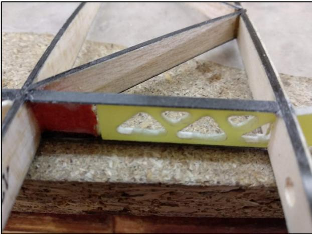
**Bild 6: Verbindungstab im Mittelteil.** Es fehlen noch die seitlichen Abdeckungen aus 0,5 mm GFK.
