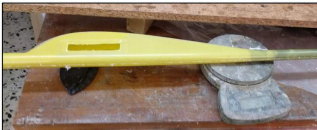
**Bild 3:** Rumpfrohling nach dem Entformen
