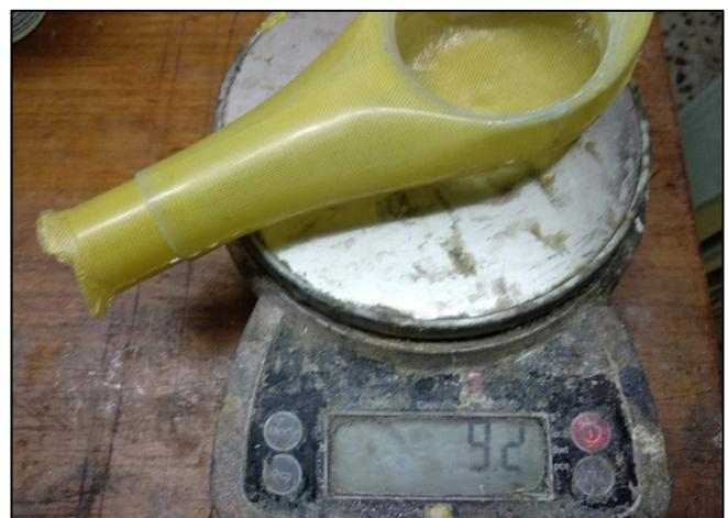
**Bild 5:** Rumpfkopf aus Aramidgewebe
