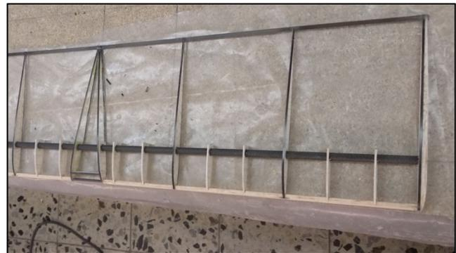
**Bild 4:** Höhenleitwerk im Rohbau
