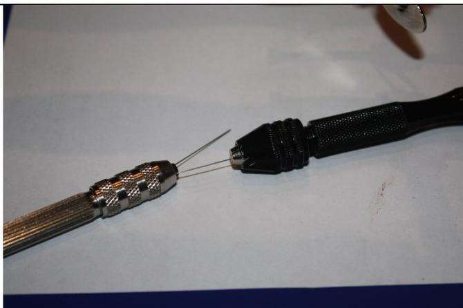
Eines der beiden Enden mit einem kleinen Bohr-Futter fixieren.
