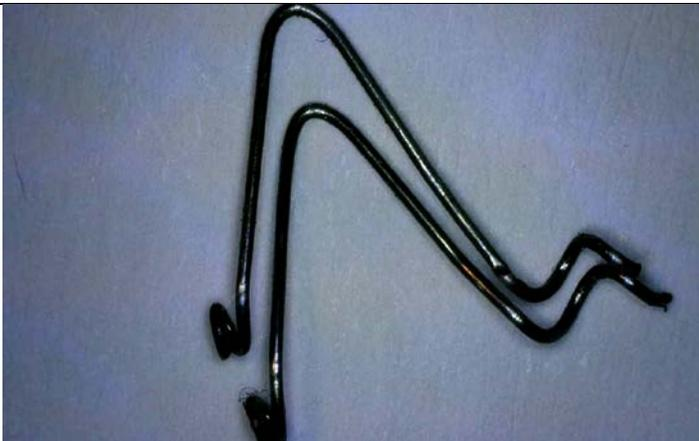
Zwei fertige Teile. Mit einem geraden Stahldraht, der späteren Propeller-Achse entsprechende Stärke, testen ob diese sich, vor allem, am hinteren Ende, einwandfrei einfädeln; eindrehen lässt !
