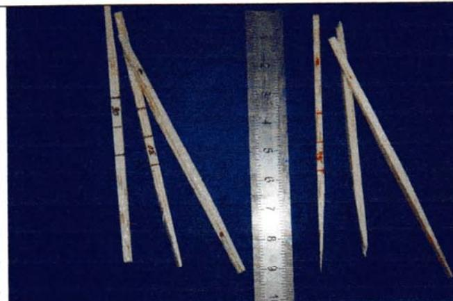
Propeller – Holme für Paddel-Propeller TH 30(160 mm)
