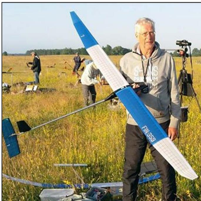
Geringe Sinkgeschwindigkeiten werden durch die Verwendung guter F1B-Profile erreicht. Die F1Q-Regeln geben keine Einschränkung des Flächeninhalts vor und es ist bekannt, dass größere Modelle bessere Leistungen erzielen können als kleinere. Mit diesen Ausgangsdaten habe ich mein neues F1Q-Modell geplant.
