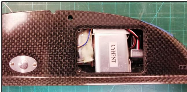
**Der Pylon mit den beiden Akkus
