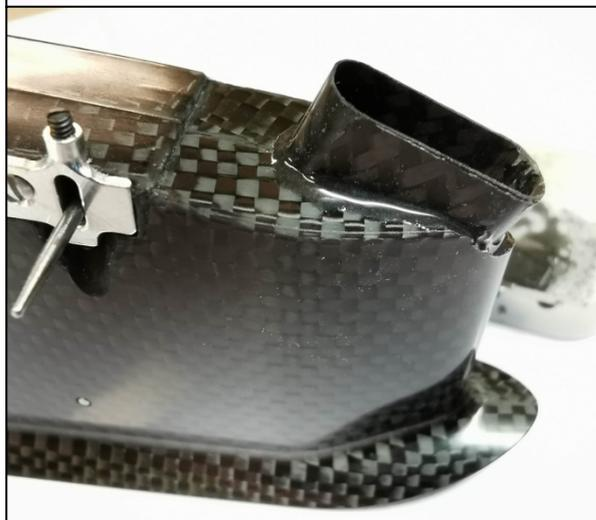
Pylon von unten mit der Hülse und fertig verklebt von oben
