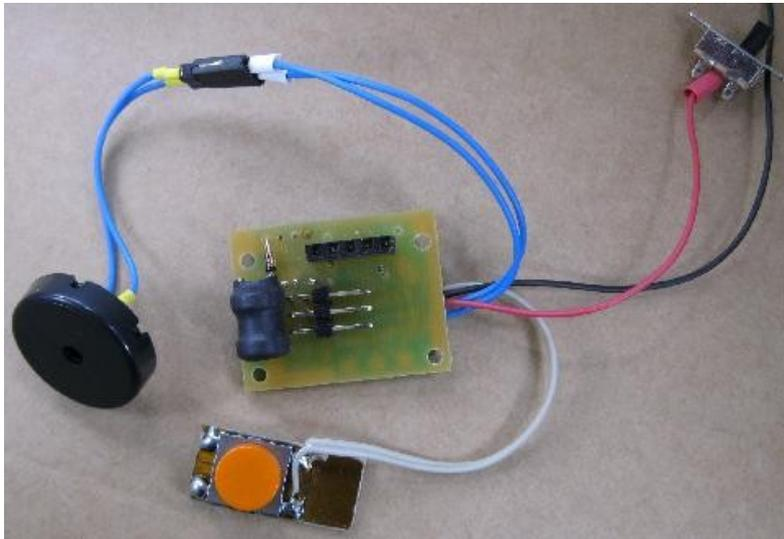
2-Servo-Timer für F1C/F1E, mit Steckerleiste, komplett beschaltet mit Starttaster, Summer, Funkbremsenanschluss, Ortungsblitz für 1S-Lipo-Akku:
