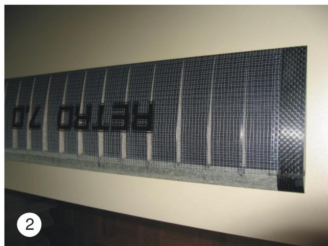
Nach den ersten Probeflügen kann ich sagen: keines meiner Modelle mit starker Unterseitenwölbung hat ein derart gutmütiges Flugverhalten. Ich glaube, eine F1B Fläche wäre einen Versuch wert. Sollte ich die Fläche meines R7 nochmals bespannen, würde ich auch die D-Box, also die gesamte Oberseite in die Bespannung mit dem Material einbeziehen.
