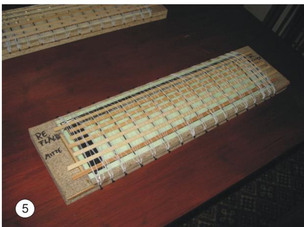
Was Sie dann von der Helling nehmen, ist im Vergleich zur Superkleber-Technik, die strukturell stabilste Rohbaufäche, die Sie je in Händen hatten. Und die, wenn Sie mit dem Epoxi sparsam waren, auch nicht schwerer ist.
