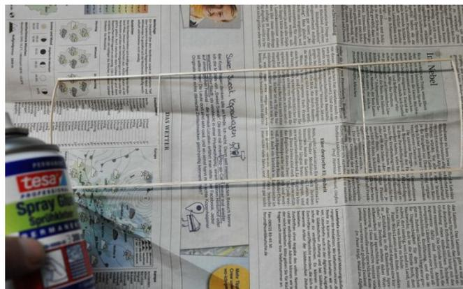
8. Balsa-Struktur auf das Baubrett legen und den Rahmen mit der Folienseite voran (unten) gleichmäßig auf die Struktur auflegen. Mit dem Finger sanft über die Strukturteile gleiten und Folie dabei andrücken.
