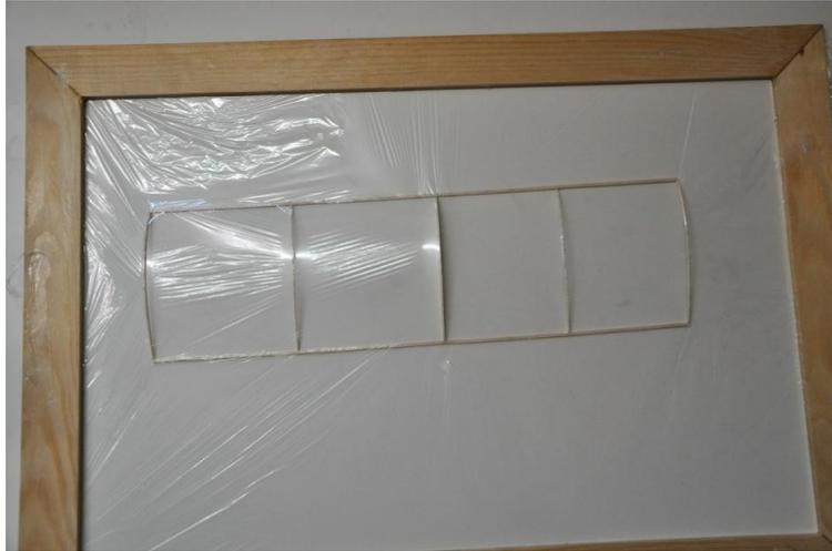
9. Struktur aus der Folie mit dem Lötkolben oder Lötnadel „auslöten“. Konzentriert und nicht zu langsam an den Umrissen entlangfahren. Bei zu langsamer Bewegung: Brandstellen. Lötkolben max. 250 bis 300 Grad. Geeignet sind besonders batteriebetriebene Lötkolben
