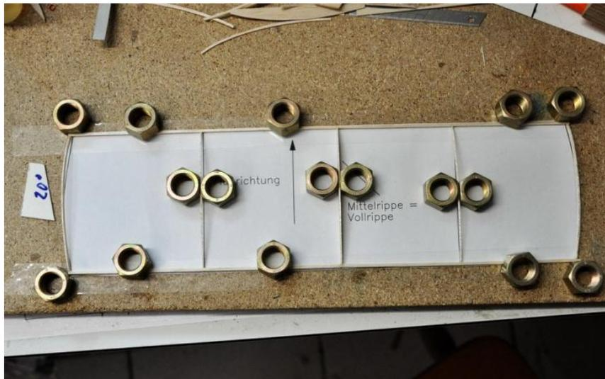
3. Rahmen aus Holzleisten ca. 3x20 mm fertigen Rahmenhöhe außen ca. 32 cm - entsprechend der Breite der Bespannfolie- , Länge außen ca. 45 cm. Der Rahmen muss 2 x mit Porenfüller lackiert und glatt geschliffen sein. Mit Fingern auf raue Stellen prüfen. Hinweis: die Bespannfolie ist gegenüber Rauigkeiten sehr empfindlich!
