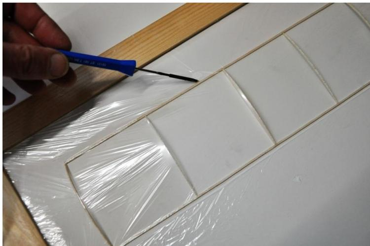
10. Bespannten Flügel wenden und an den Knickstellen unmittelbar neben der Rippe (zum Flügelende hin) leicht einritzen. Leisten von Hand nach oben brechen.
