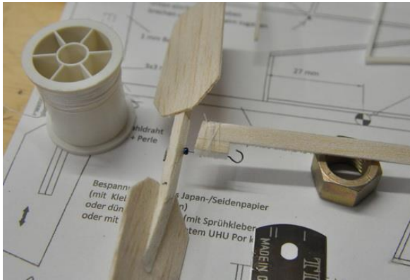
Abbildung 7 Das Lagerröhrchen aus Kunststoff (Bowdenzug) wird mit UHU pro am Rumpfrohr festgeklebt und mit einigen Fadenwicklungen fixiert. Faden verkleben. Der Propellerholm wurde zum Blatt hin mit einer Schräge versehen.
