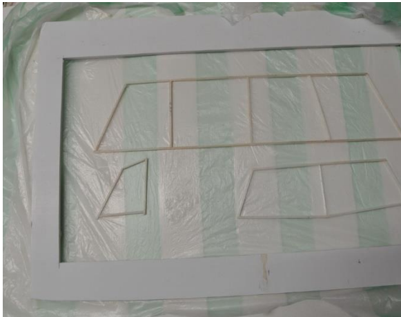
Abbildung 9 Dünne Gemüsetüten- oder Malerfolie wird mit Uhu por auf einen Karton- oder Depronrahmen punktweise fixiert und glatt gezogen. Dann werden die mit UHU por dünn bestrichenen Bauteile aufgelegt und kurz angedrückt (Uhu por mit Feuerzeugbenzin verdünnt, auftragen mit kleinem Pinsel))
