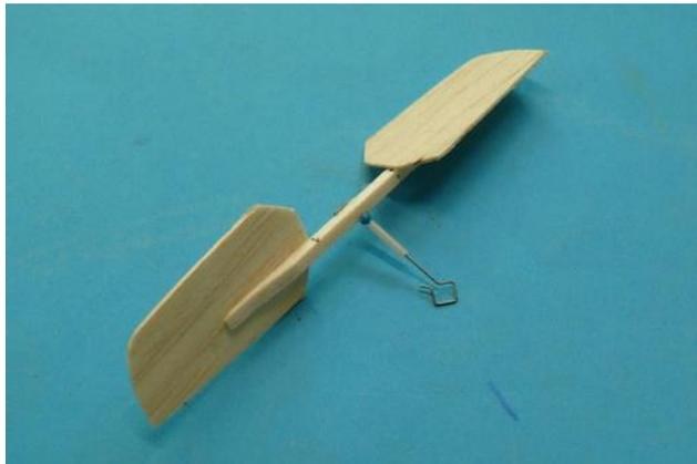
**Der fertige Propeller mit Welle, Lagerröhrchen und Perle. Der 3x3 mm Holm wurde auf den gegenüber liegenden Seiten des Blattes zum Ende hin abgeschrägt.**
