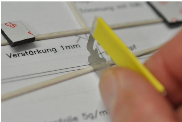
**Leisten mit der Rasierklinge ablängen (Rückseite abkleben – Verletzungsgefahr!)**
