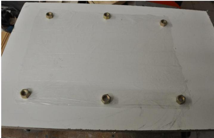
Die dünne Maler-Abdeckfolie (oder Gemüsetütenfolie vom Supermarkt) wird faltenfrei ausgelegt und mit Muttern beschwert. Die mit Sprühkleber benetzten Teile werden aufgelegt, angedrückt und anschließend die Folie ringsum mit einem LötKolben abgeschmolzen.
