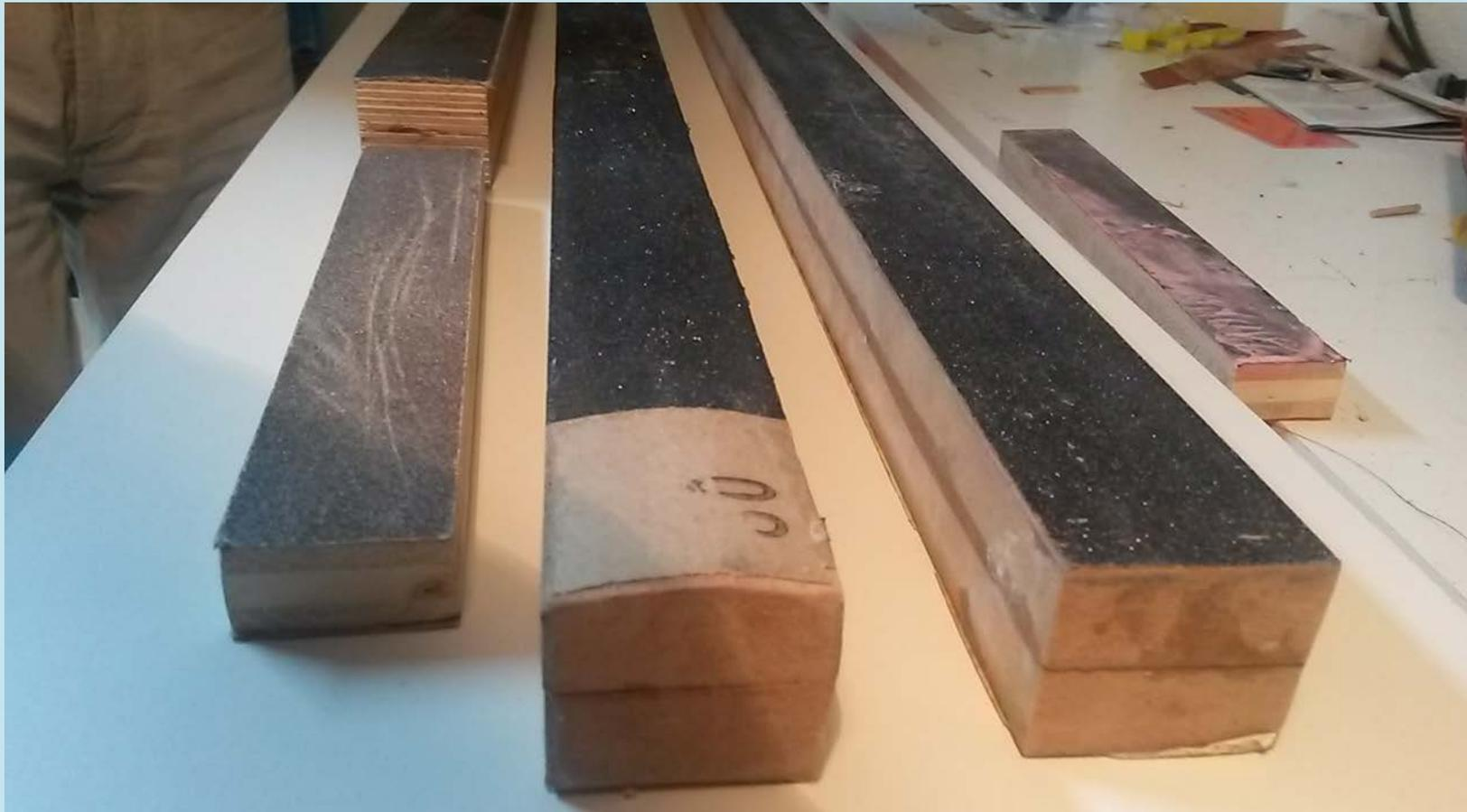
1. Mehrere Schleifklötze 90 cm und 55 cm halbrund und flach 60 Körner und 100 Körner mit Schleifband beklebt.
