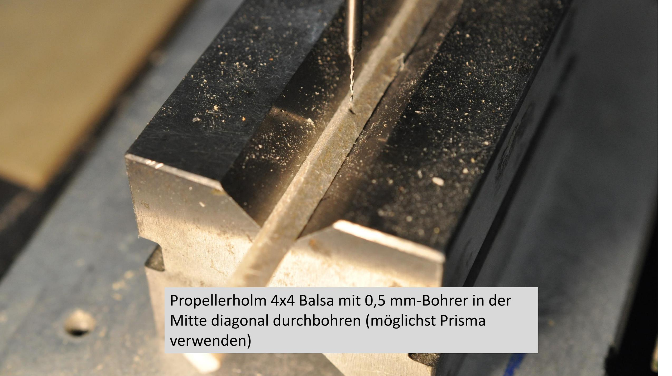
Propellerholm 4x4 Balsa mit 0,5 mm-Bohrer in der Mitte diagonal durchbohren (möglichst Prisma verwenden)
