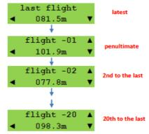
**Hinweis:** der Datenspeicher wird automatisch gelöscht wenn der Akku ab- und angesteckt wird. Er kann nicht mit dem Programmiergerät gelöscht werden.
