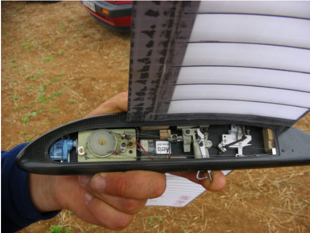
Der mechanische Rumpfkopf mit dem integrierten Aeris-RDT-Stand- Alone-System
