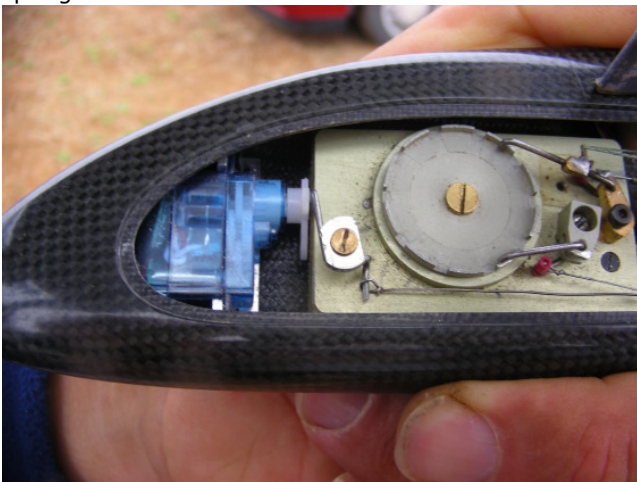
Das Servo und der Timer in der Nahaufnahme
